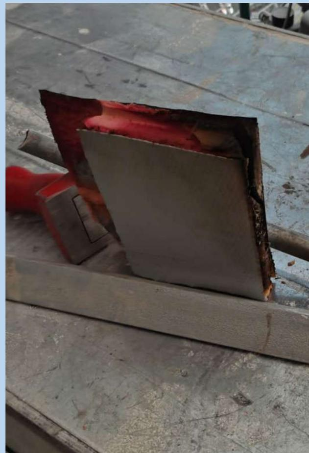
**风管板材现场燃烧试验**
