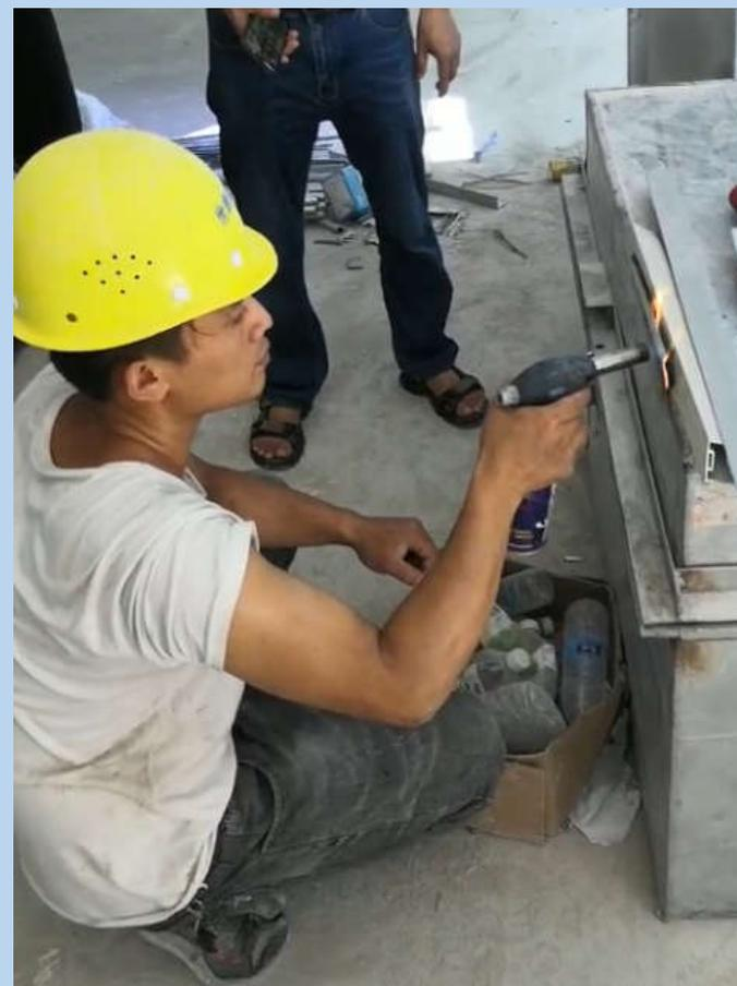
**法兰密封垫片现场点火试验**
