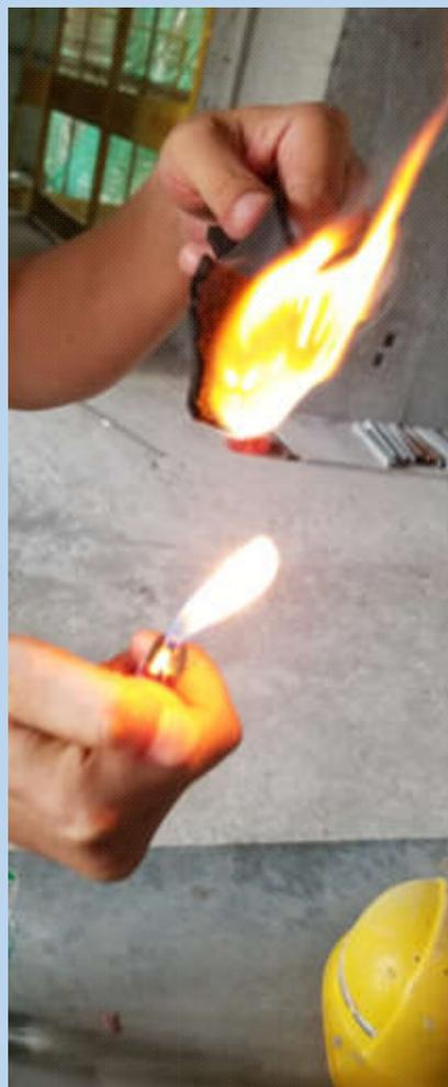
排烟风管法兰密封垫片应为**不燃材料**，法兰垫片厚度不应小于3mm。
