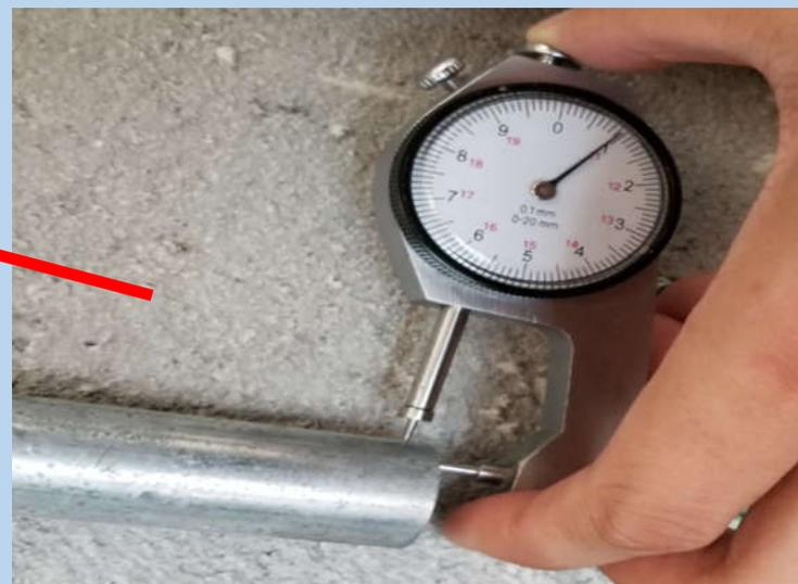
**薄壁钢管不应用于室外和埋地，易腐蚀**
